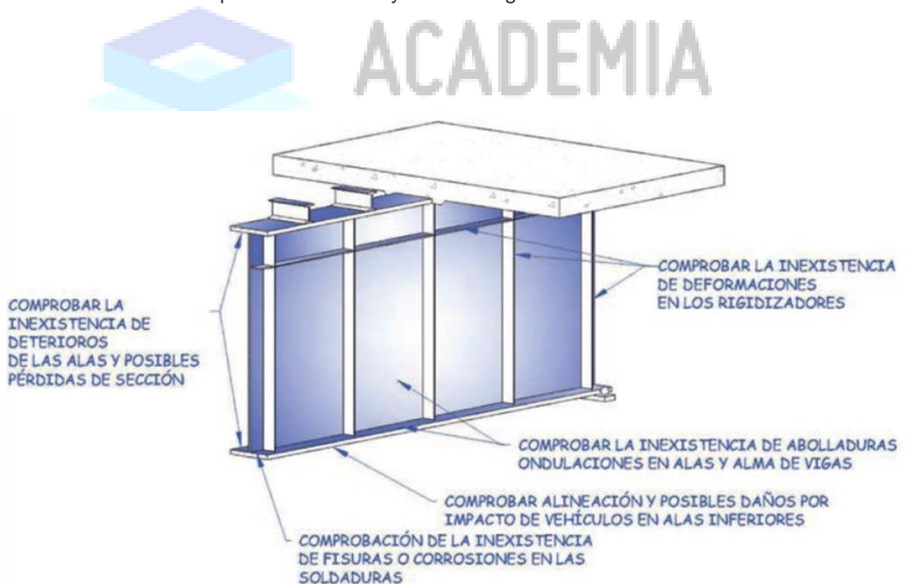
Fig. 3: Aspectos a observar durante la inspección visual de una estructura metálica de obra civil.
