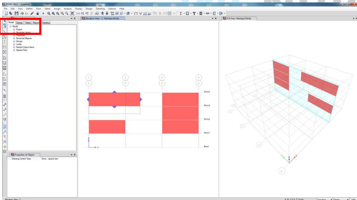
Si queremos hacer un área dentro de un contorno de vigas, no de Grid, seleccionamos en **Draw Objects Using** la opción **Perimeter Lines**:
