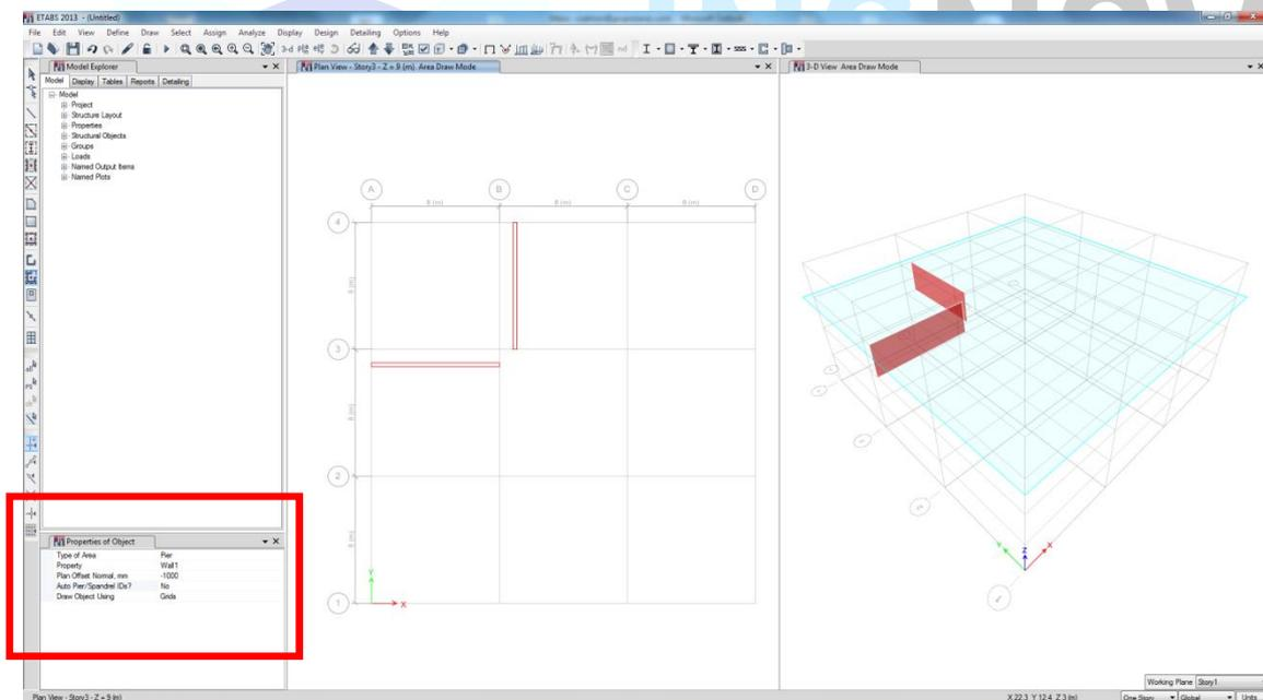
El programa tiene implementados unos muros predeterminados que podemos utilizar pinchando en **Draw Wall Stacks (Plan, Elev, 3D)**:
