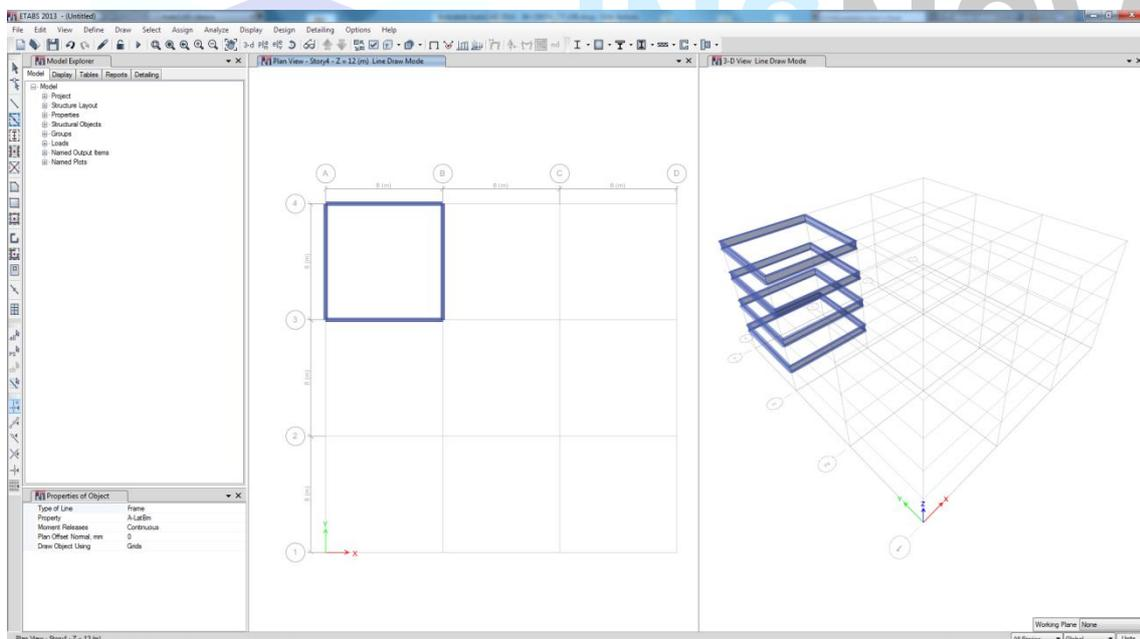
Vamos a ver a continuación el dibujo rápido de columnas, pinchamos en **Quick Draw Columns (Plan, 3D)** y podemos dibujar un pilar, los siguientes pueden hacer referencia a los ya dibujados:
