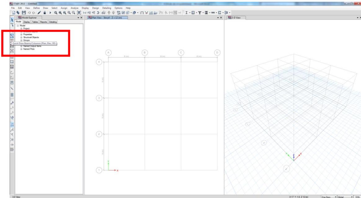
Si nos situamos tanto en planta como en 3D entre 2 sobre una línea de **Grid**, pinchando nos sale la viga dibujada en esa línea:
