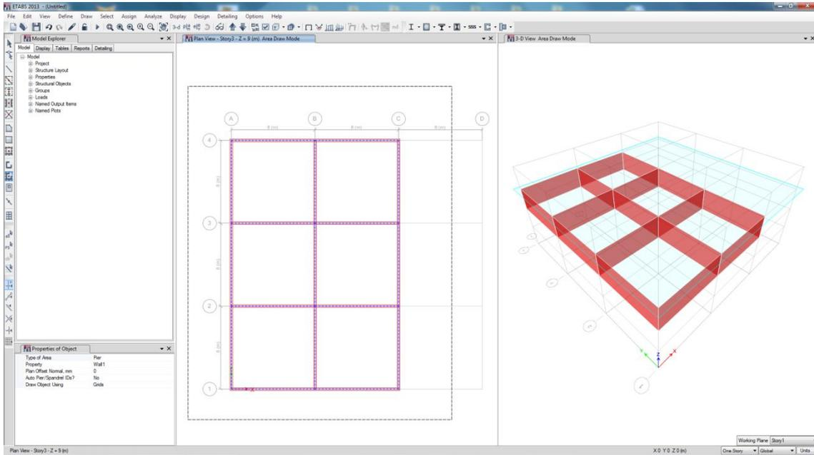
Utilizando la opción **Plan Offset Normal** podemos establecer a que separación de la línea de **Grid** queremos nuestro muro, por ejemplo a una distancia de -1000mm:
