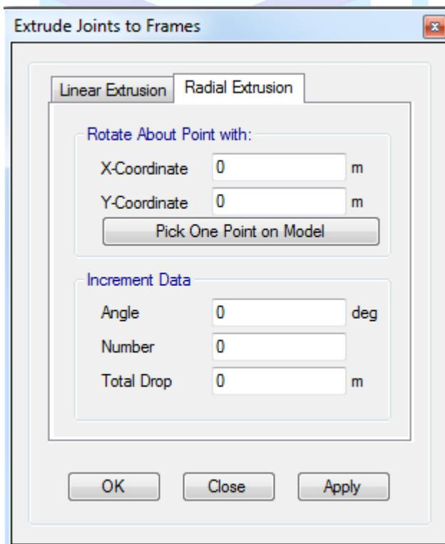
Ponemos el origen de coordenadas como punto de giro y nos pide el ángulo de rotación, el número de veces que replica y un incremento de altura, ponemos 10° de ángulo 36 veces, para que en total gire 360°. Incremento de altura dejamos 2 metros para ver que nos deja una hélice, damos a **Apply**:
