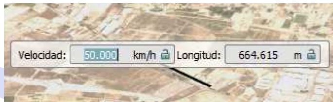
Dibujo de carretera de diseño. Solicitud de velocidad de proyecto
