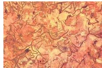
*Micrografía de la Fundición Gris (de grafito laminar)*
