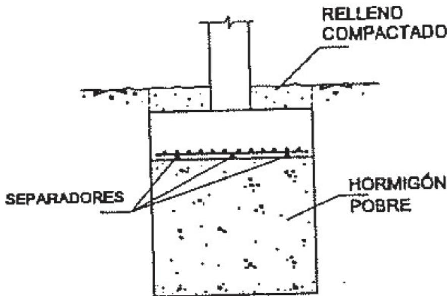
Para obtener nuestras tensiones en el terreno, tenemos que sumar las producidas por la carga transmitida por la zapata más el peso del pozo, despreciando el rozamiento en las paredes del mismo con el terreno, del lado de la seguridad.
