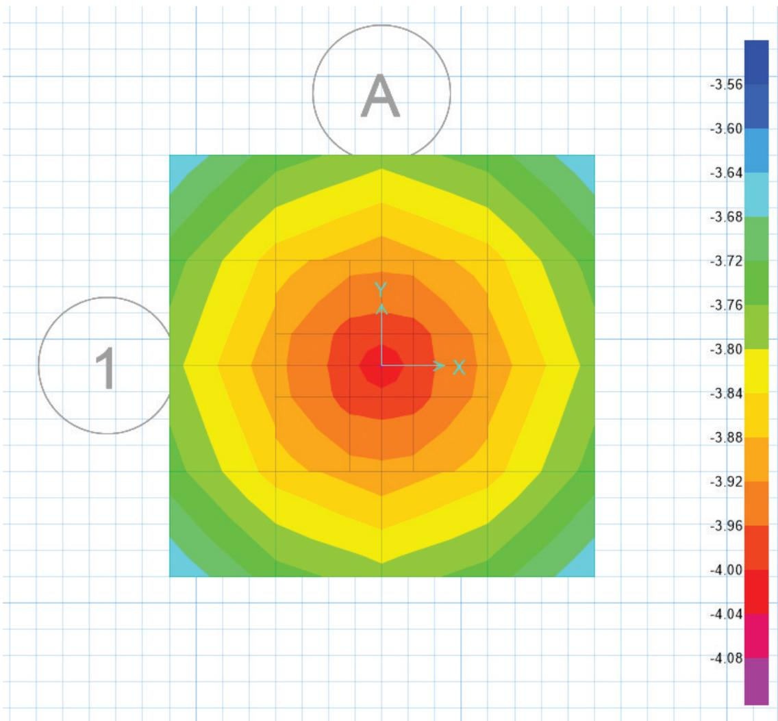
En este modelo podríamos ver si hay despegues entre zapata y coronación de pozo. Según la normativa que estemos manejando, puede exigirse la inexistencia de despegues o la limitación de los mismos a un determinado porcentaje de la superficie en planta.
